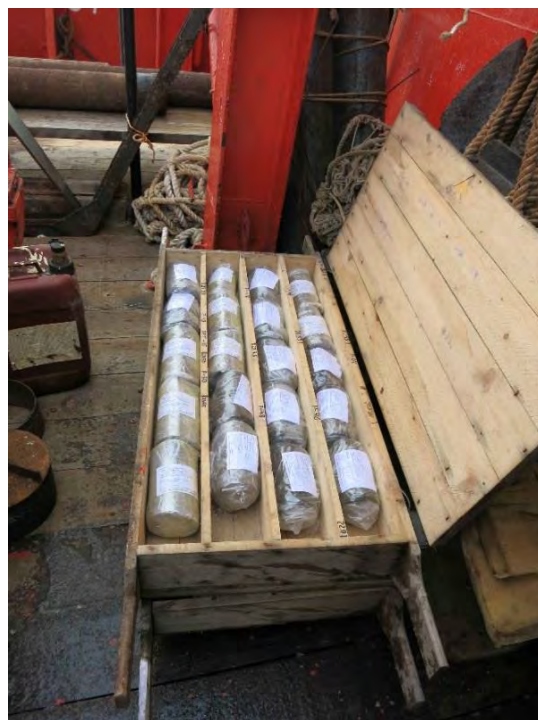
Рисунок 2.2-4. Пример упаковки образцов керна
