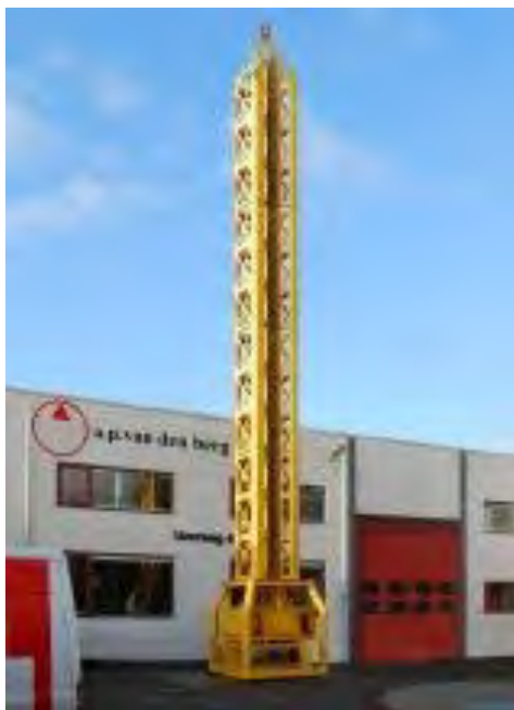
Рисунок 2.2-2. Установка статического зондирования Deep Water Roson 75/100kN
