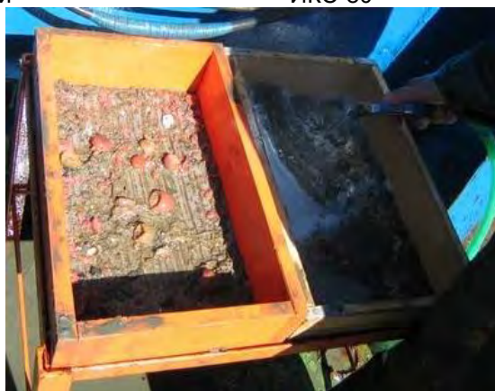
Дночерпатель Ван-Вина и сито для промывки грунта
