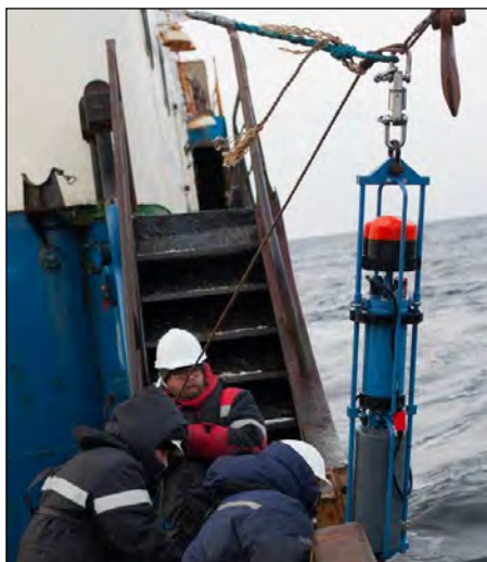
Рисунок 5.6-6. Постановка АБС с акустическим доплеровским профилографом течений RDСР 600 SW
