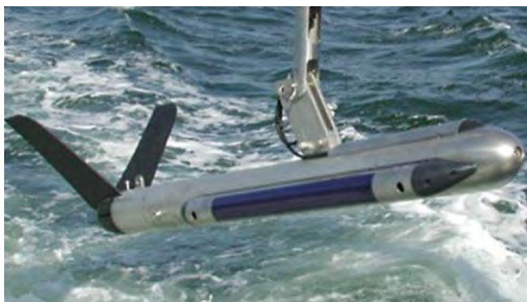
Рисунок 5.4-1. Внешний вид гидролокатора Klein 3000
