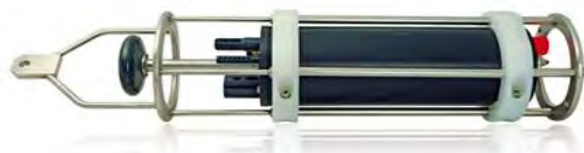
Рисунок 5.6-5. Мультипараметрический измеритель Valeport Midas ECM Profiler
