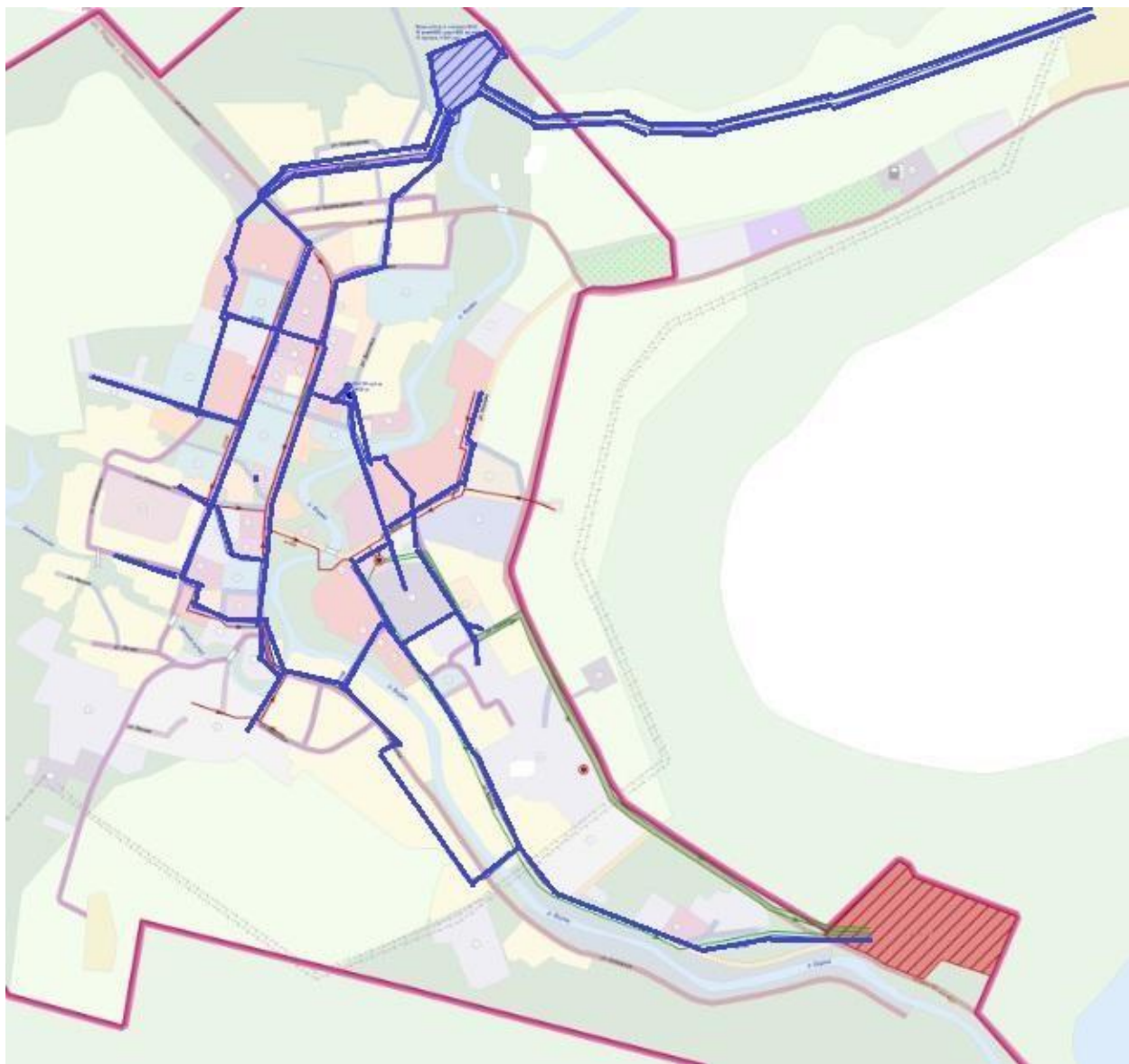
Рисунок 1 - Схема водоснабжения с. Ловозеро
