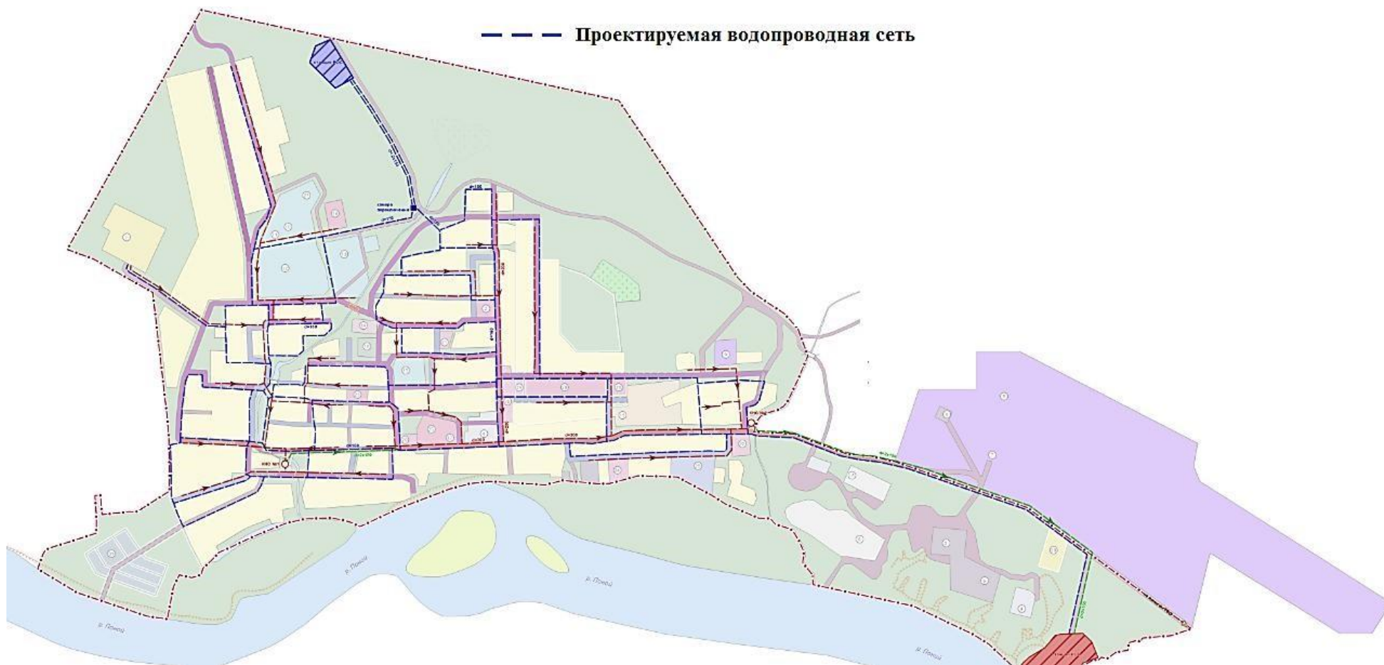
Рисунок 27 - Проектируемые водопроводные сети с. Краснощелье
